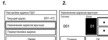
Адрес для данного модуля может быть задан в диапазоне от 1 до 32. Однако, не следует задавать то же значение, что и для адреса ДУ внутреннего модуля, подключенного тем же кабелем ДУ.
