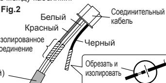
(2) Подключите кабель пульта ДУ к соединительному кабелю и вставьте его в разъем. Переключите DIP-переключатель (SW1) на печатной плате внутреннего модуля в положение «2WIRE» (ДВУХЖИЛЬНЫЙ).
