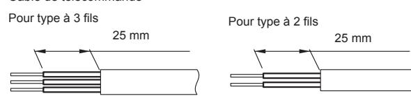
• Raccordez les câbles de télécommande et de transmission comme illustré à la Fig. A.
