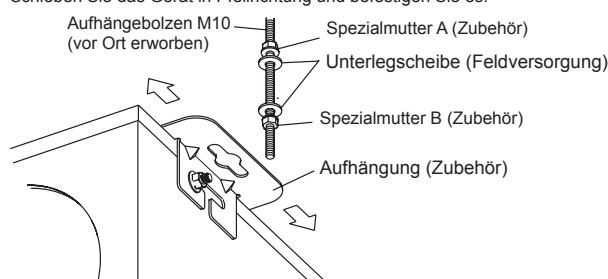
**Tragfähigkeit der Bolzen** 9,81 bis 14,71 N.m
