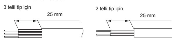
• Uzaktan kumanda ve iletim kablolarnı Fig. A'da gösterildiği gibi bağlayın.
