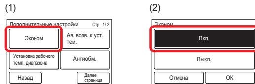
После касания [OK] данные передаются на внутренний блок, а затем дисплей возвращается к экрану «Дополнительные настройки».
