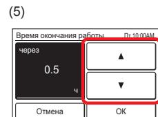
При касании [OK] дисплей вернется к экрану «Таймер Выключения».
