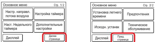
При выборе каждого элемента отображается экран установки. Для подробной информации по каждому значению смотрите описание. Когда каждая установка завершена или отменена, дисплей вернется к этому экрану. При касании [дисплей] дисплей вернется к экрану режима монитора.
