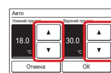
После нажатия [OK] дисплей вернется к экрану «Установка». После касания [Назад] на экране «Установка» дисплей вернется к экрану «Установка рабочего темп. диапазона».
